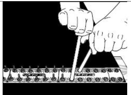
11. Обломите выступающие концы болтов используя специальный обламыватель Bolt Breaker
