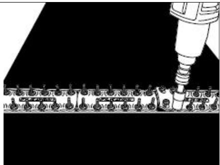
10. Затяните все гайки от краев к центру с одинаковым усилием. Отрежьте лишнюю часть ленты Flexco-Lok.
